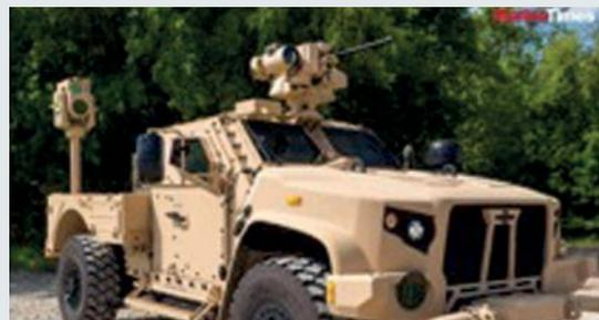
Abb. 9: Boeing-CLWS-Anti-Drone-Laser der US Marines
